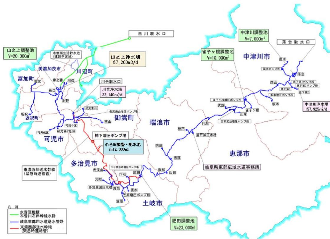
岐阜県東部（東濃・可茂）の取水・送水の系統
