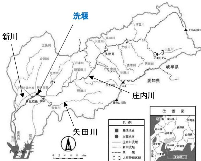
ない流下能力の乏しい河川です（特定都市河川浸水被害対策法の指定河川となっています）。このような新川に庄内川の洪水を洗堰から流し込んでいることが、2000年9月の新川決壊の原因なのです。何より、名古屋市が庄内川左岸側の排水機場（約300 m<sup>3</sup>/s）を運転し続け、その排水量と同じ約300 m<sup>3</sup>/sが洗堰から新川に流れ込み、新川は再び水位が上昇して決壊しました。洗堰は、左岸側の排水機場の排水によって庄内川の水位が上昇するのを抑えるはけ口となっているのです。しかし、新川が洗堰からの流入水によって流量が増大して氾濫することを前提とする対策は全くとられていません。新川は自流域の流出水も十分に流すこともできないにもかかわらずです。
