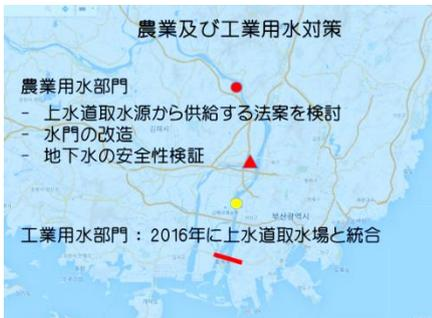
農業用水への影響が長良川と同じく議論になっています。図の△は、日本の統治時代に作られた農業用水の水門です。釜山市の西の金海（キメ）市に流すものです。ここではもともと河口堰以前から農業が行われていたのだから堰開門で塩害というのはおかしいのです。水門の改善でも対処できます。地下水に影響が出るのではといわれますが、実験すれば分かることです。また、上流に釜山市水道の100万トン/日の取水口がありますが、実際には60万トン/日しか使いませんので、その
