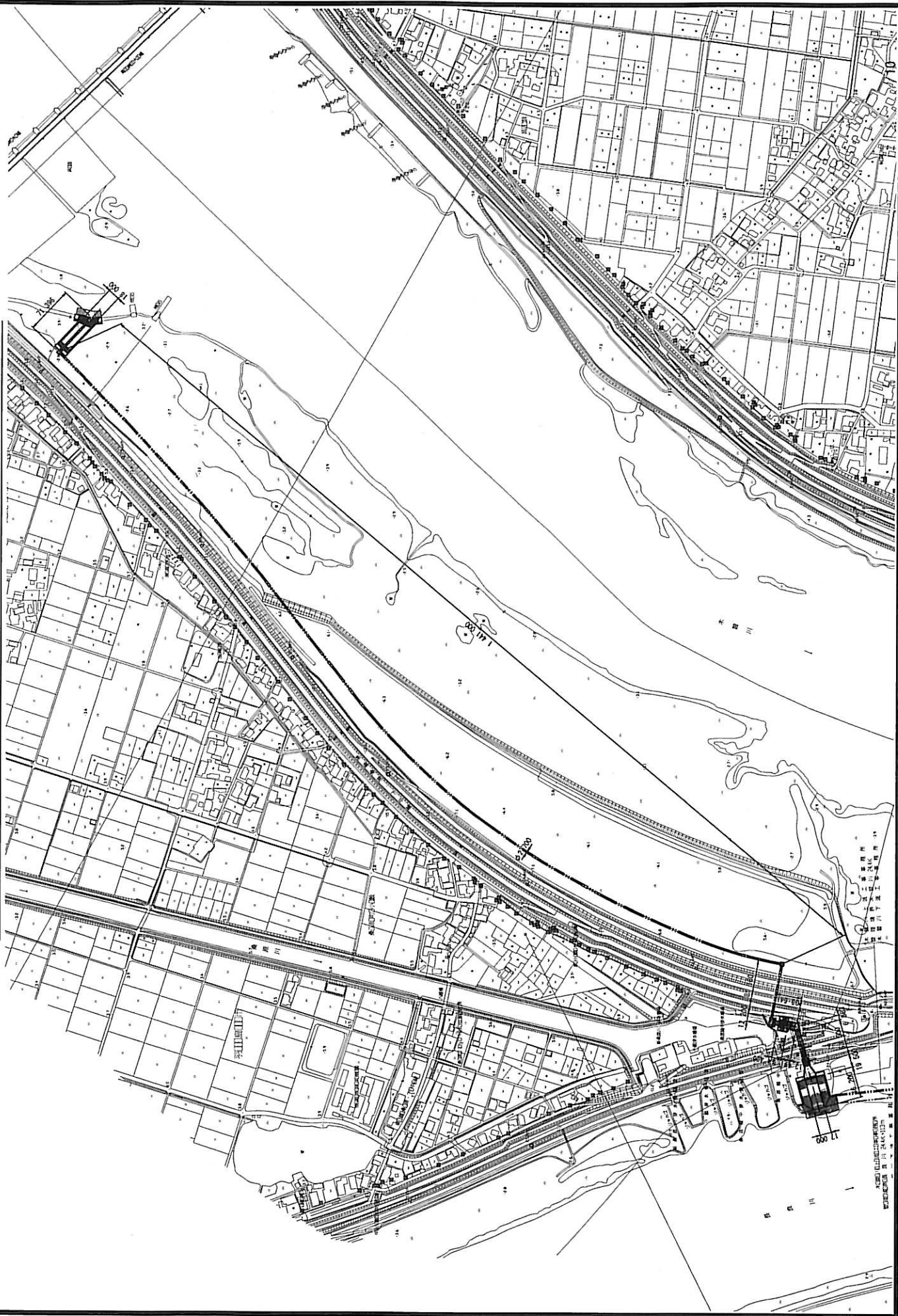
木曾川導水路（最下流案）全体平面図 Q=11.5 \text{ m}^3/\text{s} S=1:2500
